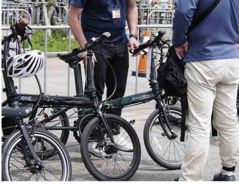
36V/9.5Ahの「シートポスト型バッテリーを搭載した「K-ONE」と「UNIO」。5モードのパワー選択ができる。
